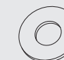
W-C /PL/ D6 podkładka (x6) /EN/ D6 washer (x6) /DE/ D6 Unterlage (x6)
