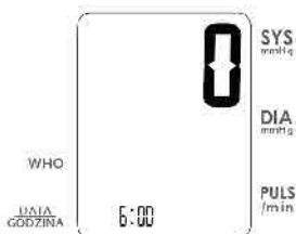
Automatische Einstellung der Null.
