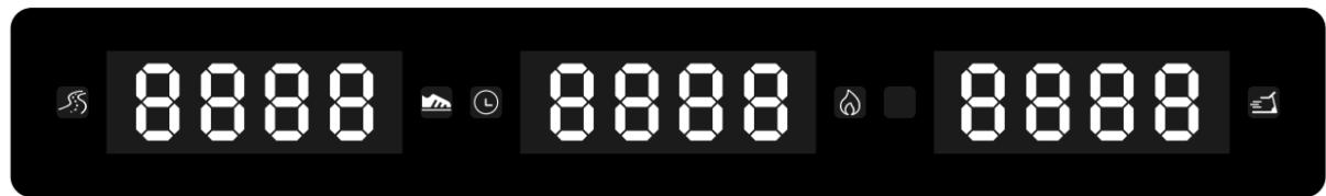
1. Čas / kalorie: displej během tréninku střídavě zobrazuje informace o čase tréninku a spálených kaloriích . Rozsah zobrazení času je : 00-99 : 59 , když čas dosáhne hodnoty 99:59 tak se vynuluje a počítá od 0 ; rozsah kalorií je 0-9999, když hodnota dosáhne 9999, tk se restartuje a počítá od 0.
