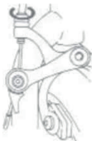
rys. 12b regulacja napięcia linki hamulca
