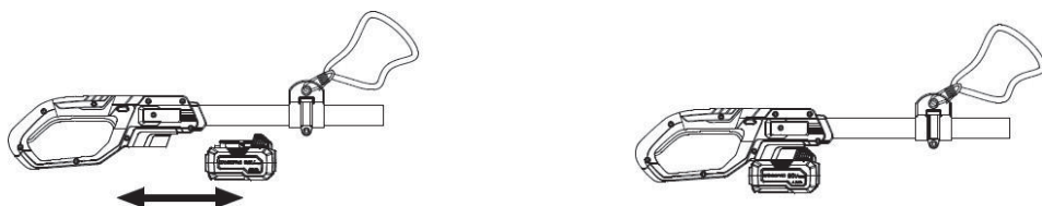
Obrázok 4: Inštalácia batérie (batéria nie je súčasťou príslušenstva)
