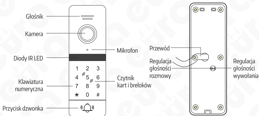
Rys. 1 Budowa kasecy zewnętrznej
