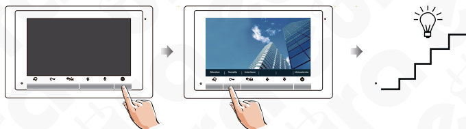
Rys. 16. Włączanie/ wyłączenie oświetlenia
