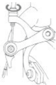
rys. 12b regulacja napięcia linki hamulca
