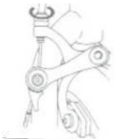
rys. 12b regulacja napięcia linki hamulca
