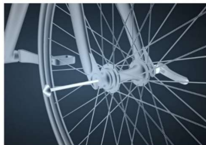
Rysunek 2 – włóż „szpilkę” przez koło i dokręć nakrętkę po lewej stronie
