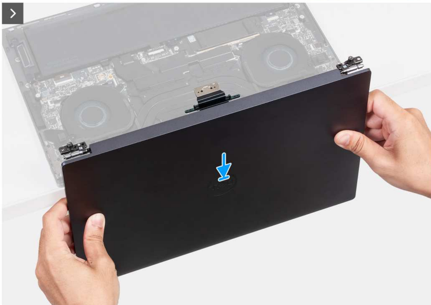
Rysunek 30. Instalowanie zestawu wyświetlacza
