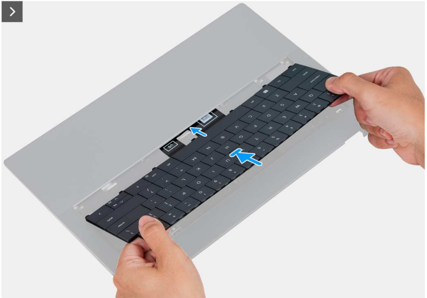
Rysunek 43. Instalowanie klawiatury
