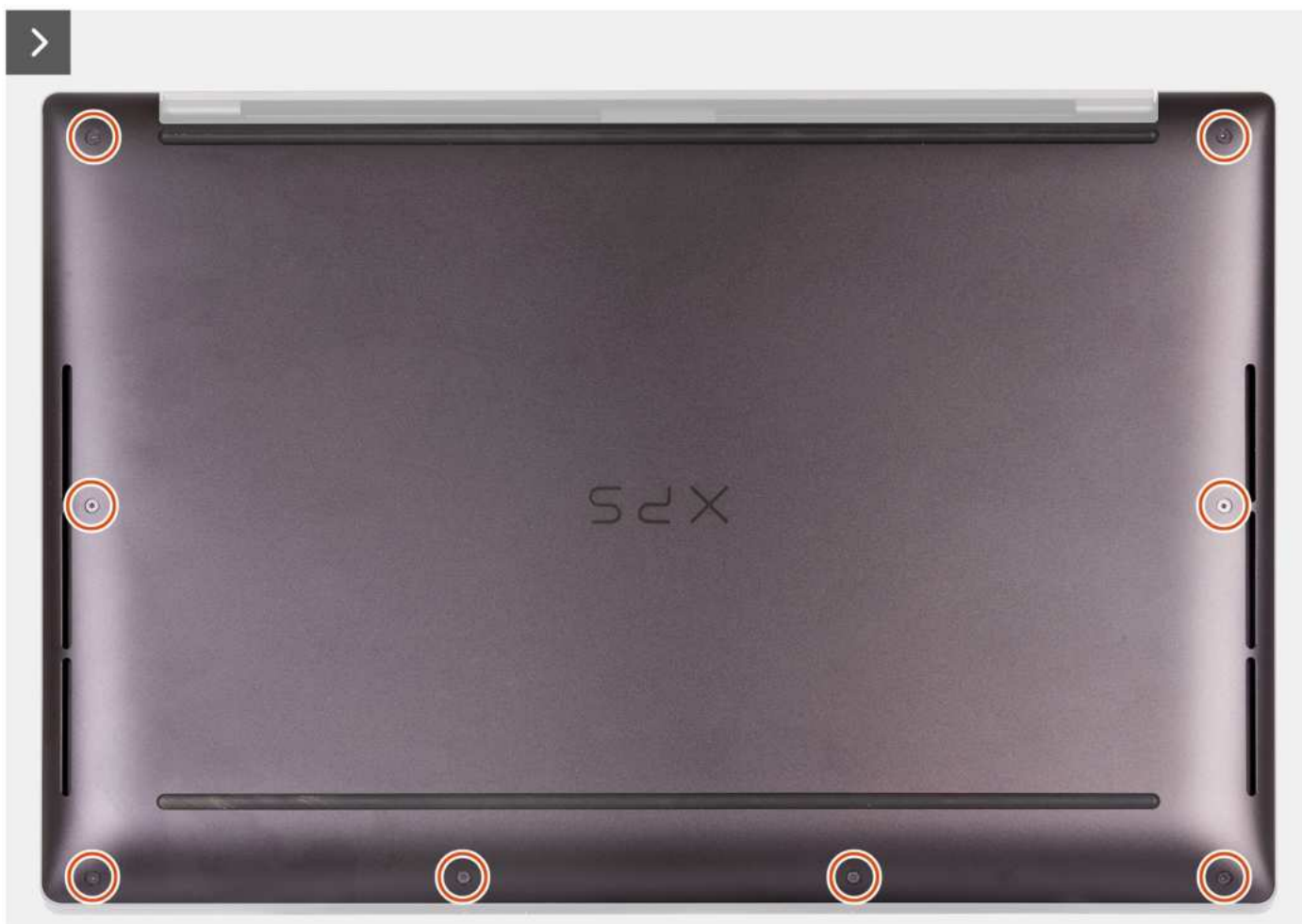
Rysunek 9. Wymontowywanie pokrywy dolnej
