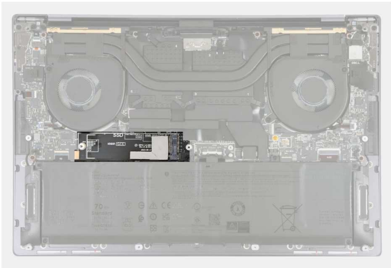
Rysunek 20. Podkładka termoprzewodząca dysku SSD M.2
