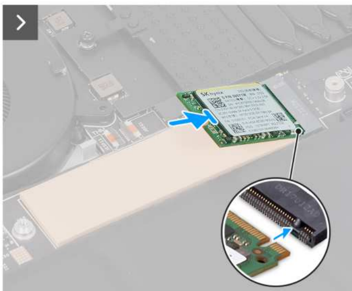
Rysunek 21. Instalowanie dysku SSD M.2 2230
