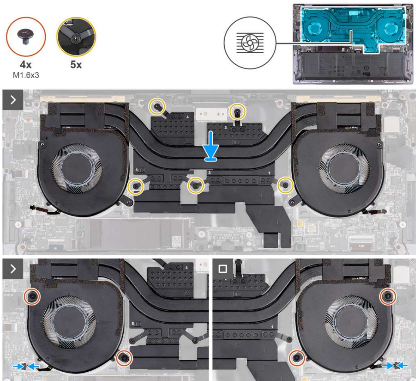
Rysunek 26. Instalowanie zestawu radiatora
