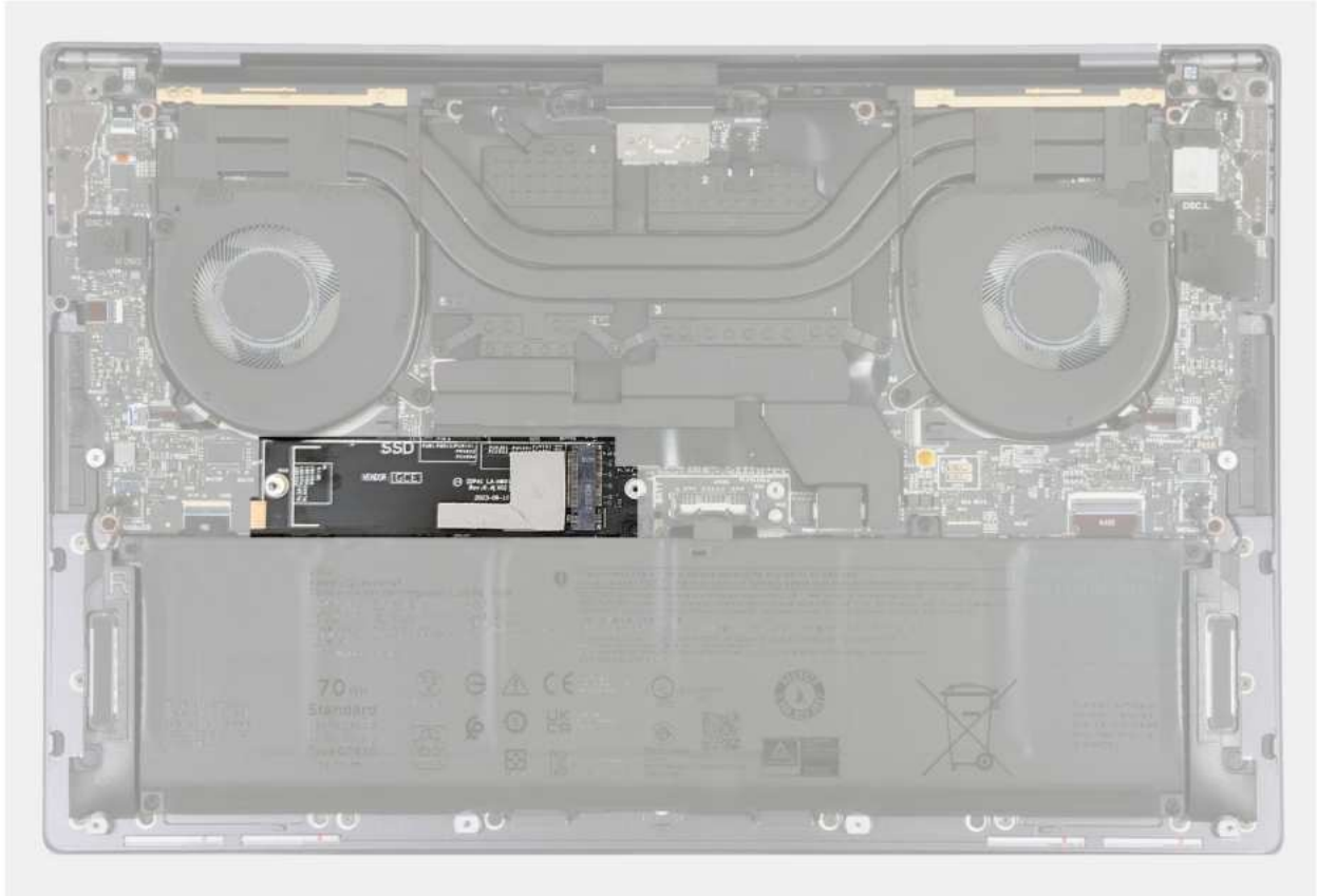
Rysunek 23. Podkładka termoprzewodząca dysku SSD M.2
