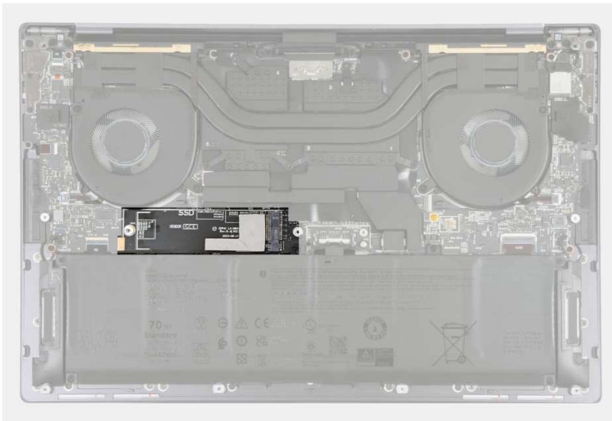
Rysunek 19. Podkładka termoprzewodząca dysku SSD M.2
