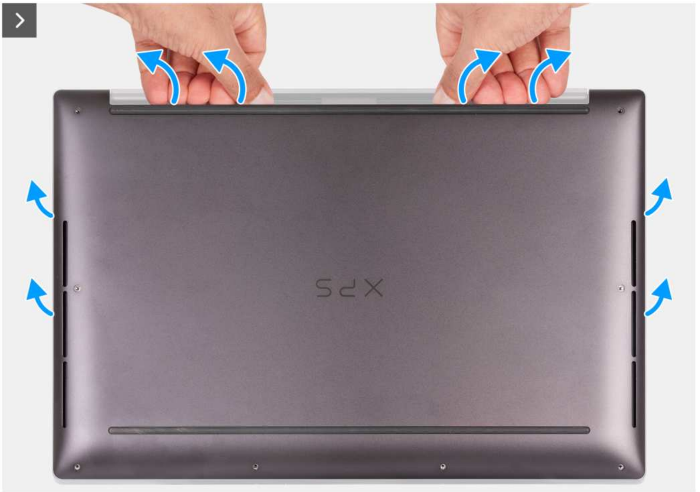
Rysunek 10. Podważanie pokrywy dolnej za pomocą kciuków
