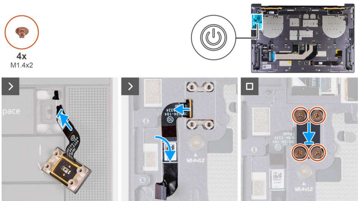
Rysunek 40. Instalowanie przycisku zasilania z czytnikiem linii papilarnych
