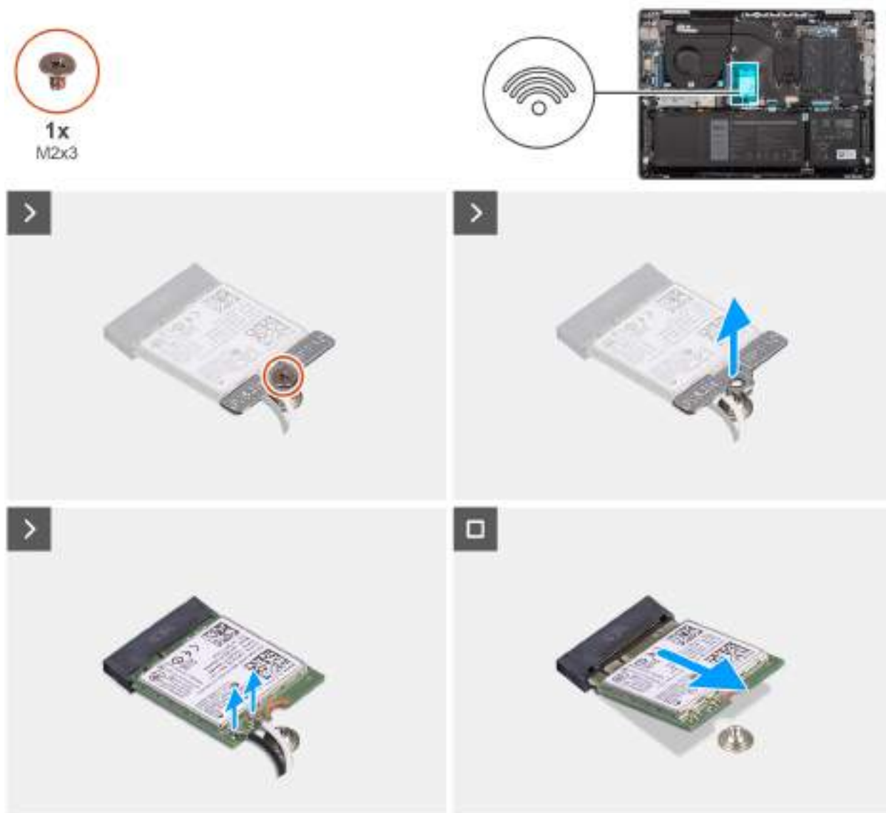
Rysunek 21. Wymontowywanie karty sieci bezprzewodowej
