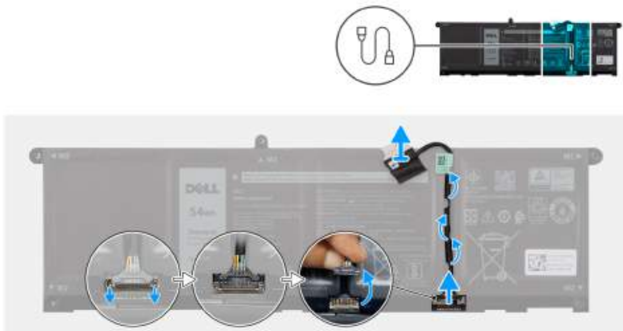
Rysunek 27. Odłączanie kabla baterii
