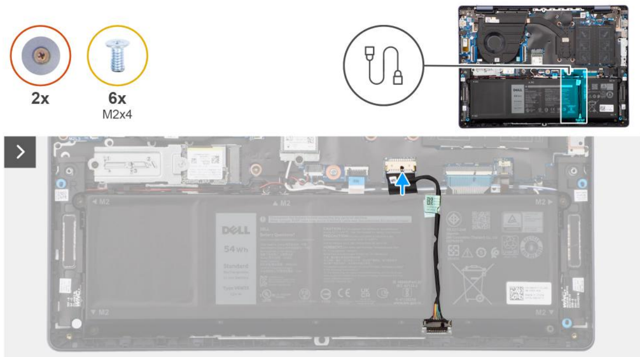
Rysunek 14. Podłączanie kabla baterii
