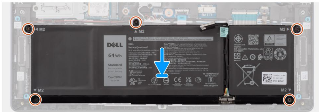
Rysunek 35. Instalowanie baterii 4-ogniowej
