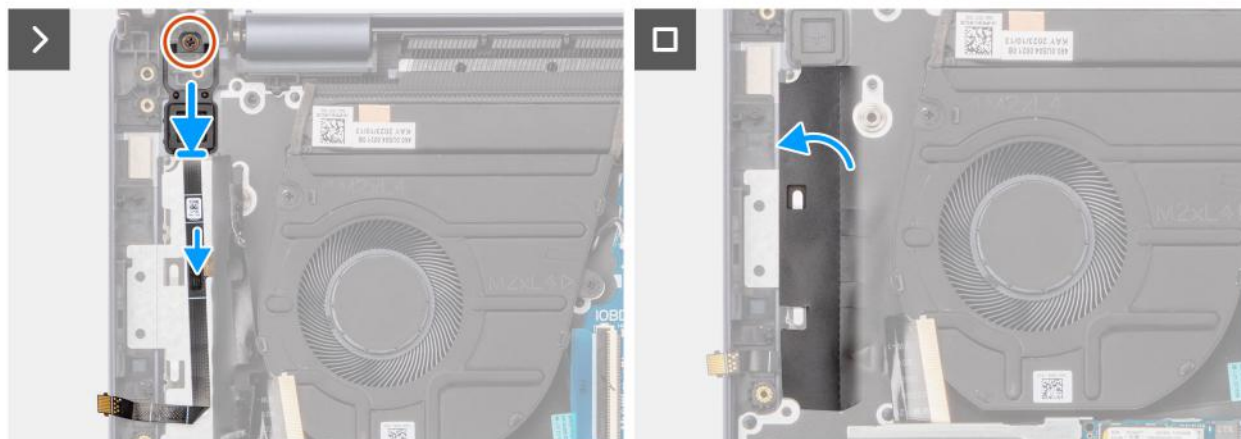
Rysunek 61. Instalowanie przycisku zasilania z opcjonalnym czytnikiem linii papilarnych
