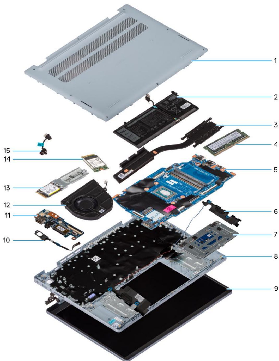
Rysunek 9. Główne elementy komputera Inspiron 14 5445
