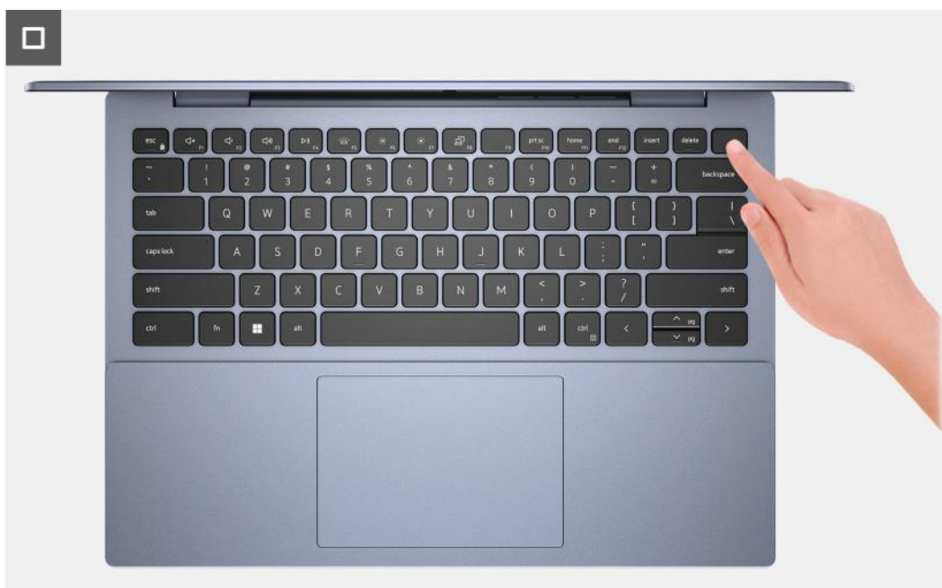
Rysunek 20. Naciskanie przycisku zasilania w celu rozładowania ładunków elektrostatycznych
