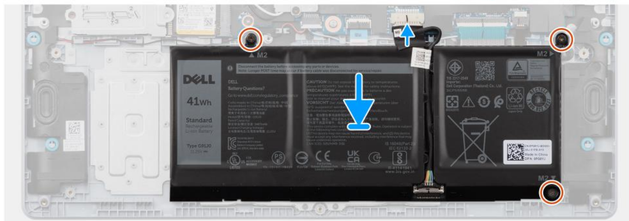
Rysunek 33. Instalowanie baterii 3-ogniowej
