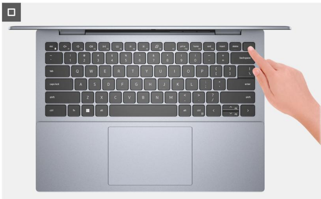
Rysunek 13. Naciskanie przycisku zasilania w celu rozładowania ładunków elektrostatycznych
