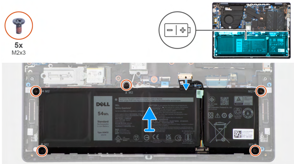
Rysunek 40. Wymontowywanie baterii
