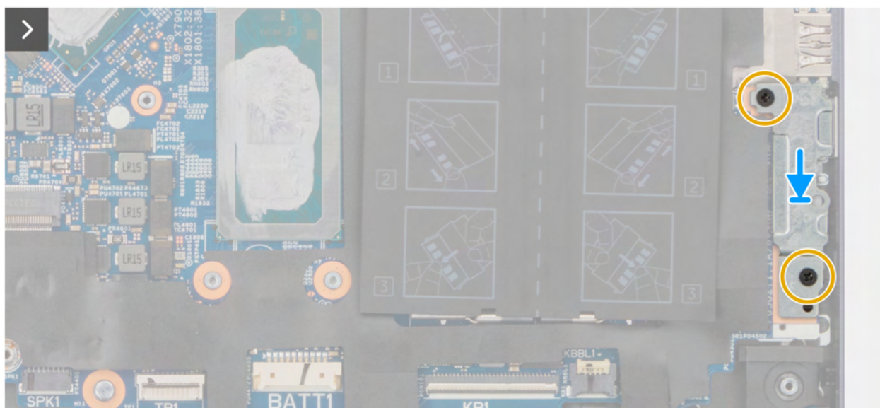
Rysunek 108. Instalowanie klamry portu USB Type-C
