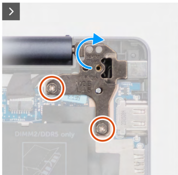
Rysunek 50. Wymontowywanie gniazda zasilacza
