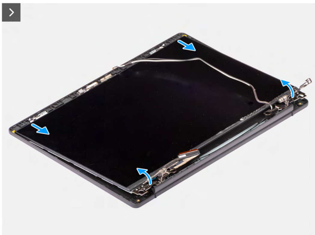
Rysunek 80. Wymontowywanie wyświetlacza
