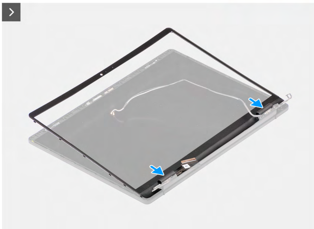
Rysunek 77. Instalowanie ramki wyświetlacza
