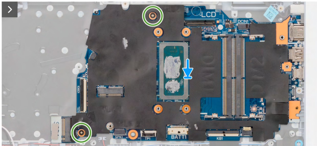
Rysunek 98. Instalowanie płyty głównej
