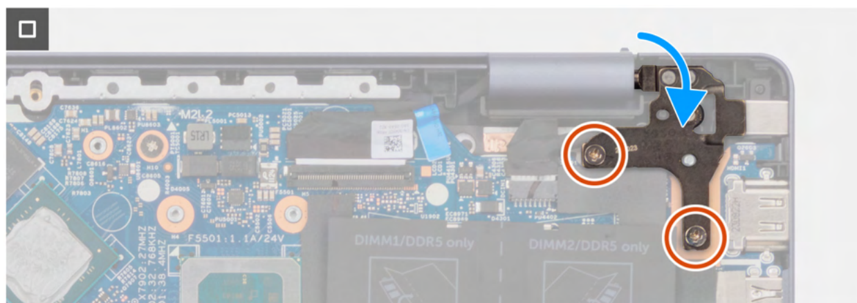
Rysunek 110. Wkręcanie śrub zawiasów
