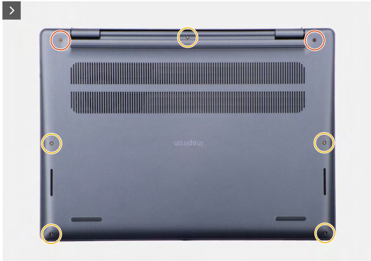
Rysunek 15. Wymontowywanie pokrywy dolnej
