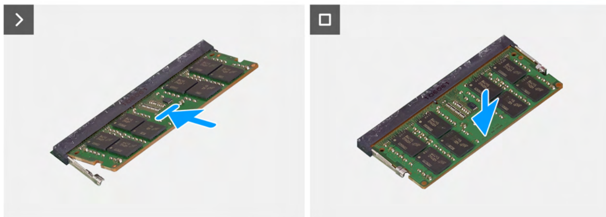
Rysunek 21. Instalowanie modułu pamięci
